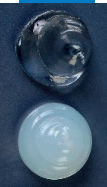
Grado de transparencia del Mapeflex MS Crystal Clear vs la opacidad de un silicón tradicional
