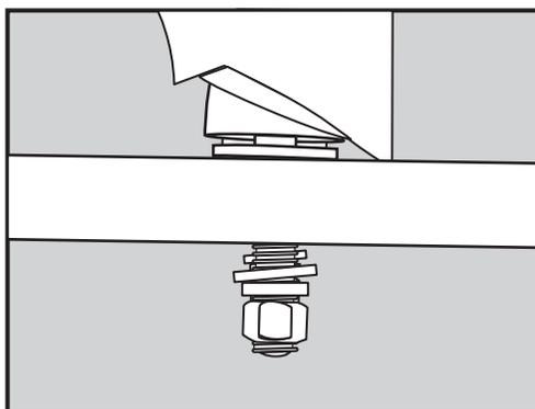
Alinear correctamente el asiento del inodoro e instalar la arandela metálica, la arandela de seguridad metálica y tuerca de metal en el poste de la bisagra.
