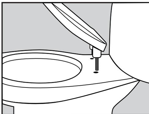
Inserte la bisagra en los orificios de los tornillos del inodoro asegurándose de que la arandela de goma suave está por debajo de la bisagra y en la parte superior de la taza del inodoro.
