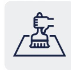
7. Respetando las normas de instalación, se debe esperar 72 horas antes de rejuntar la baldosa. El rejuntado se debe realizar con espátula de silicona/goma, etc.
